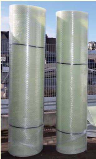
Sanierungsbedürftige Abscheider aus Beton können mit Platten aus Glasfaserverstärktem Kunststoff dauerhaft und preisgünstig ausgekleidet werden
